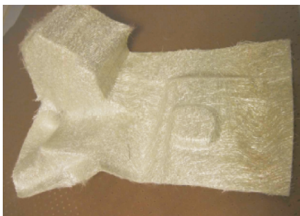
Rys. 4 Preforma wykonana z SAERflow BX304/CSM150
