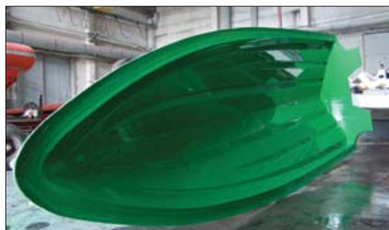
Rys. 2. Forma wykonana z żelkotu narzędziowego GCVN X60000VB30 i bez skurczowej żywicy Polymold LV150RC (zdjęcie udostępnione przez firmę Stocznia Ustka Sp. z o.o.)
