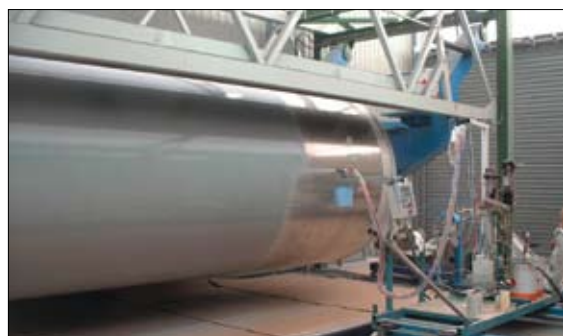
Rys. 4. Mechaniczna aplikacja topkotu (zdjęcia: materiały firmy Polyprocess)
