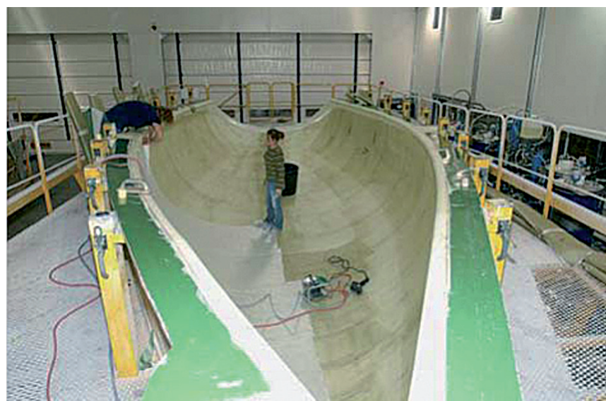
Rys. 3. Budowa kadłuba jachtu z zastosowaniem tkanin szytych
