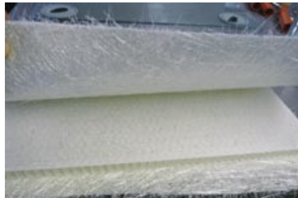
Rys. 5. Przygotowania do laminowania z użyciem materiału ThermHex.
