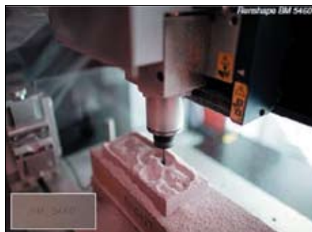
Fot. 1. Frezowanie modelu w płycie modelarskiej RenShape® BM 5460 [materiały Huntsman]
