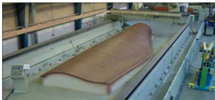
Fot. 3. RenPaste® 4503, model skrzydła do elektrowni wiatrowej wykonany techniką SMP
