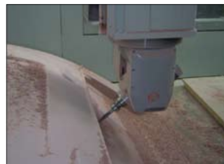
Fot. 2. Frezowanie modelu z pasty RenPaste SV/HV4503 [materiały BELLA Zakład Kompozytów Sp. z o.o.]
