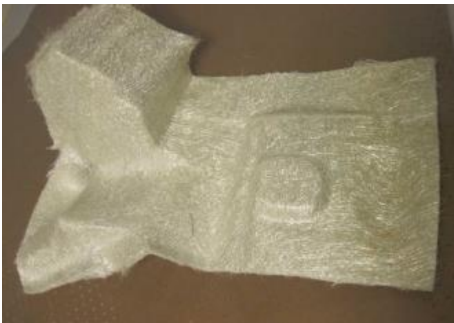
Rys. 4 Preforma wykonana z SAERflow BX304/CSM150.
