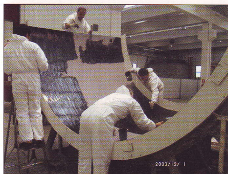
Pokrywanie powierzchni modelu żelkotem
