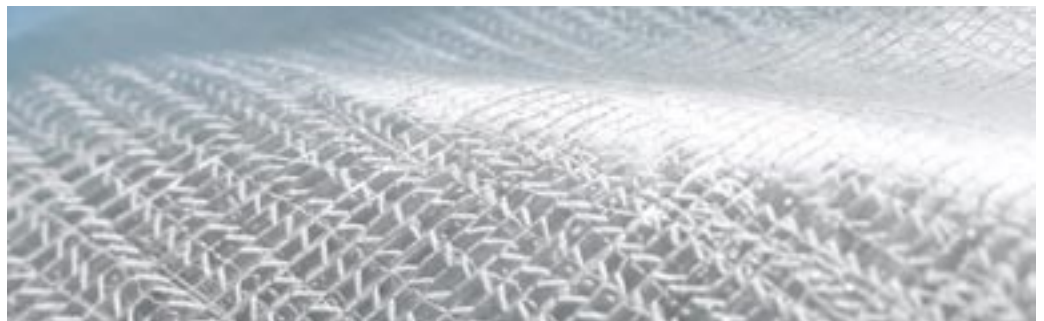
Fot. 1. Zbrojenie mocowane jest do formy za pomocą kleju w sprayu lub poprzez zastosowanie tkanin ze specjalną błoną klejową, takich jak SAERfix.
