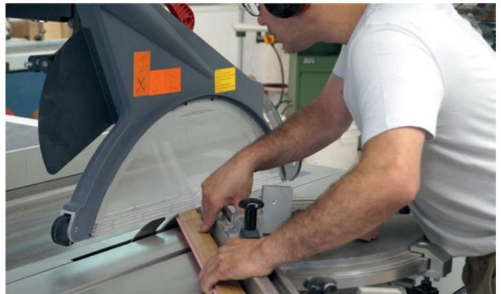
maridur® lässt sich ähnlich wie Holzwerkstoffe bohren, schleifen und verschrauben. maridur® can be drilled, sanded and screwed similar to wood.
