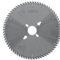
Die empfohlene Schnittgeschwindigkeit liegt bei 70 - 90 m/sec. Bei polykristallin diamantbestückten (DP) Kreissägeblättern ist der obere Wert zu wählen. Es ist ein Vorschub pro Zahn von 0,06 - 0,07 mm anzustreben.
